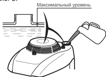
Рис. 8 Максимальный уровень топлива в топливном баке
